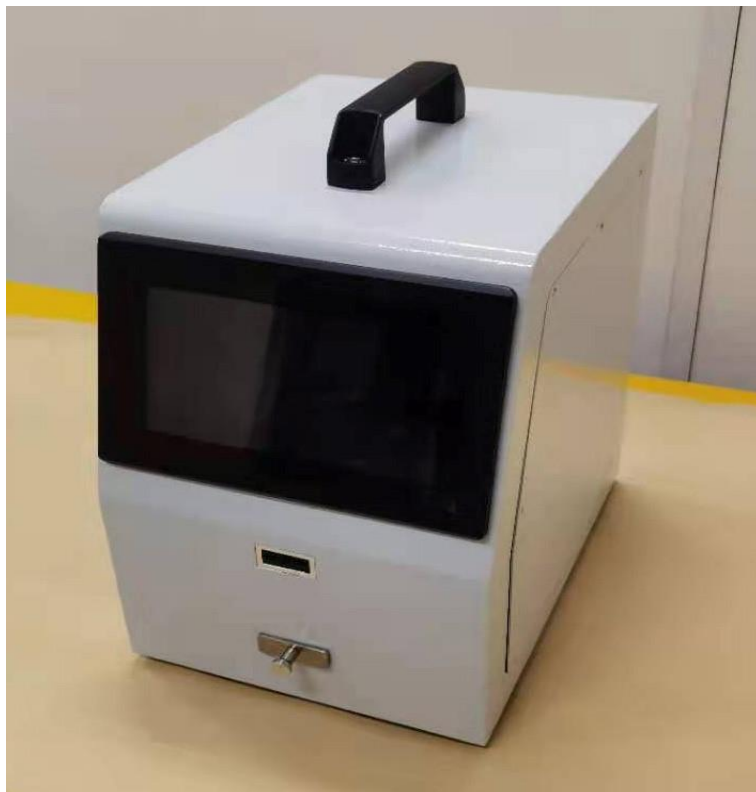
图 1 IAB-01 型便携式 \alpha 、 \beta 计数器
