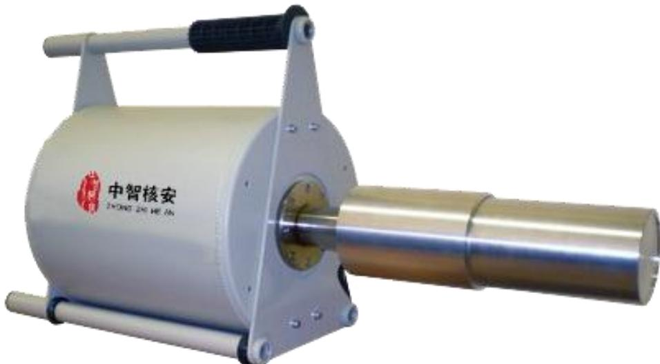
图 1 PHPGe-D 型便携式液氮制冷 P 型高纯锗  $\gamma$  能谱仪
