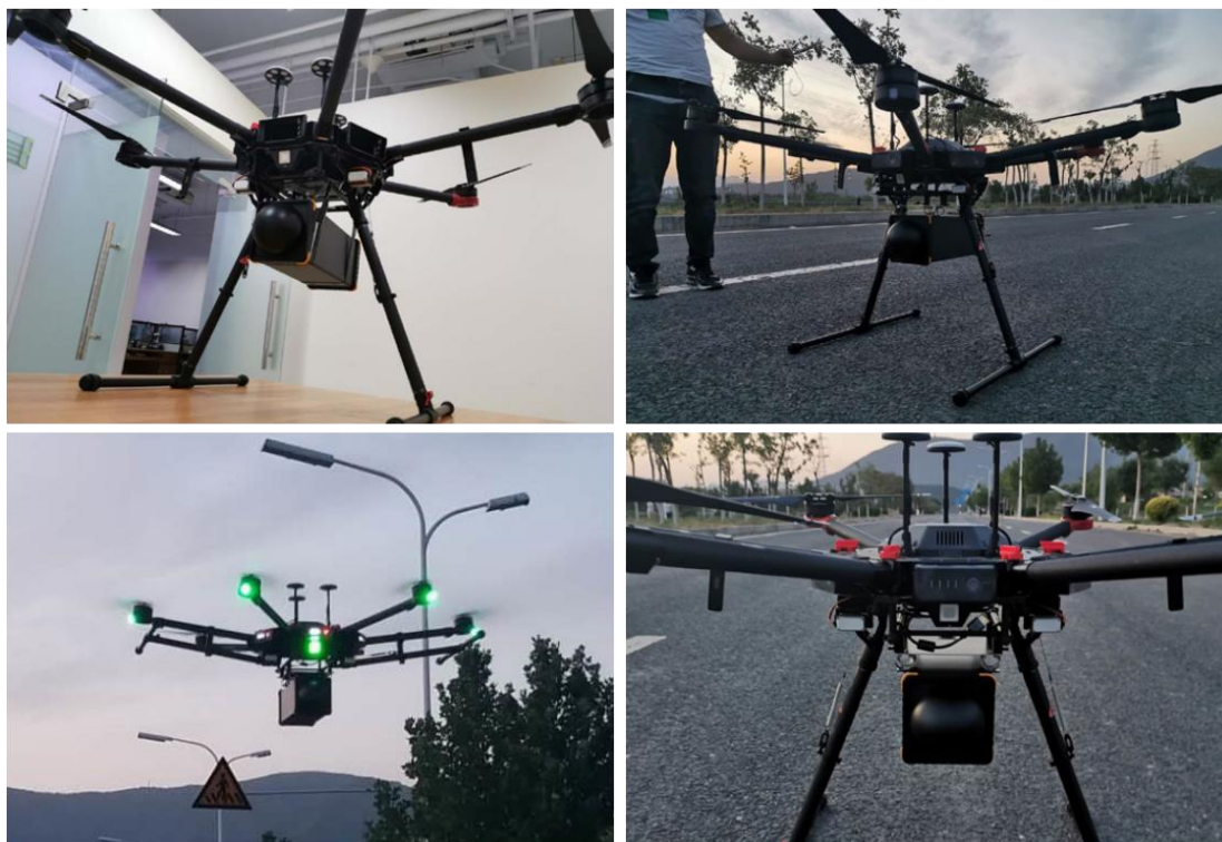
图 1 DJDetective--NaI-2×2-GM10 型无人机航测系统外观
