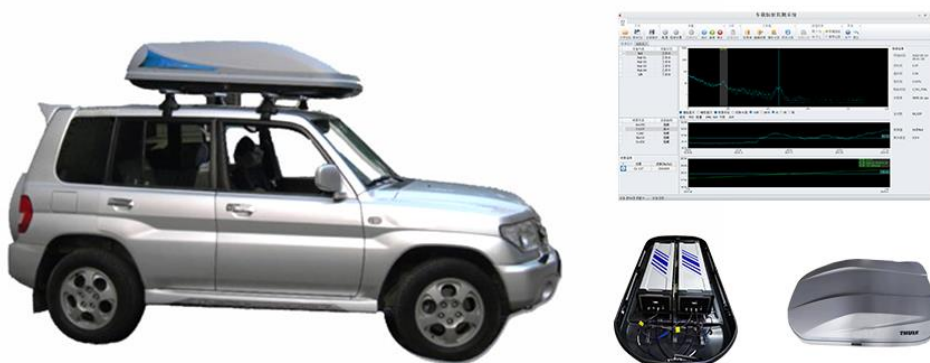
图 1 HJ2000 车载大体积巡测谱仪
