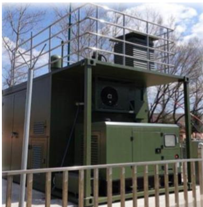
图 1 超大流量采样高纯锗全自动大气辐射监测站
