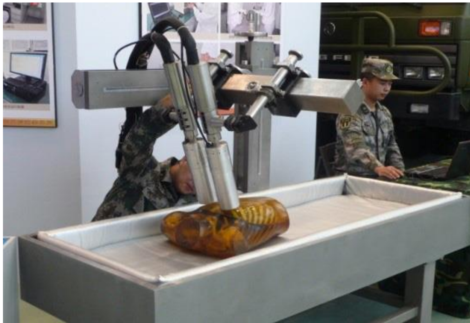
图 1 肺计数器测量人体模型现场应用
