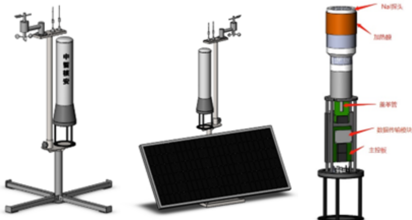
图 2 GammaAutostation-GM-10 型投放式辐射剂量检测系统结构示意图
