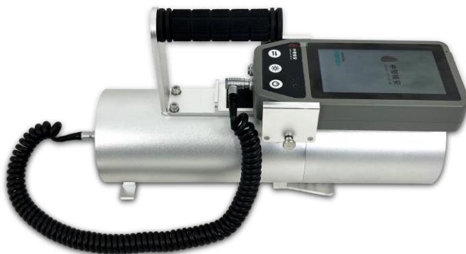
图 1 Triples-PLN-9090 型便携式环境级  $\gamma$  剂量率仪
