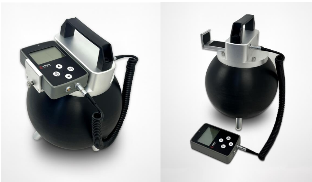
图 1 Triples-H3-100 型中子周围剂量当量率仪
