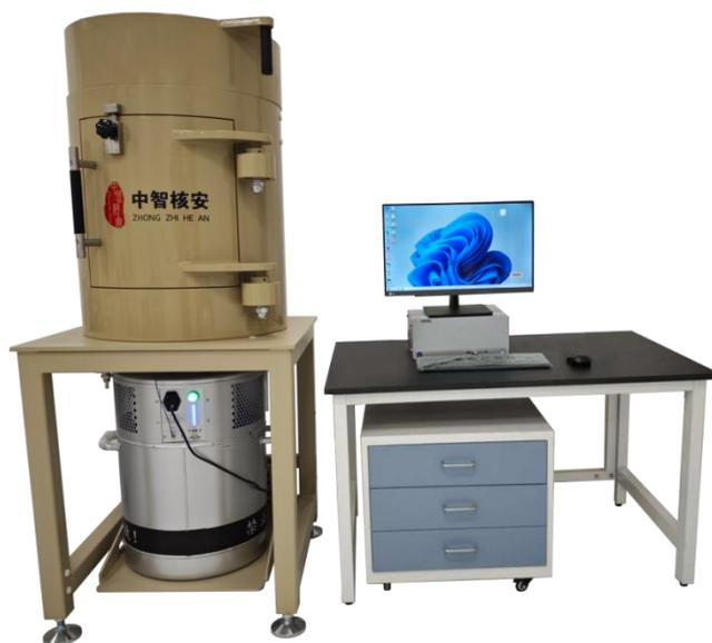
图 2 GammaLin 型高纯锗  $\gamma$  谱仪现场应用照片
