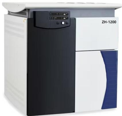
ZH-1200 低本底液体闪烁计数系统能够高灵敏度地测量多种放射性核素，如  $^3\text{H}$ 、 $^{14}\text{C}$ 、 $^{32}\text{P}$  等，对低能  $\beta$  核素尤为有效。支持自动换样、显示和打印结果，可一次测量多个样品，并自动进行数据处理和分析。能够测量样品的淬灭程度，并通过校正来提高计数效率。通过设置不同道宽等条件，系统可以测量同一个样品中的双标记或三标记放射性，区分出各个标记的放射性强度。
