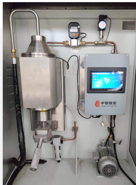
图 1 ADI-300 空气中碘连续监测仪 (固定式，可改装为移动式)
