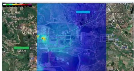
图 3 利用放射性巡测谱仪测量结果生成放射性连续分布并定位放射源热点图
